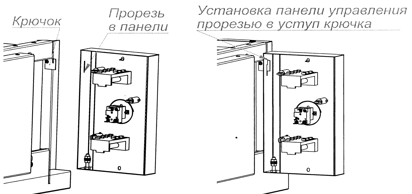
Рис. 8 Схема установки панели управления при ТО
